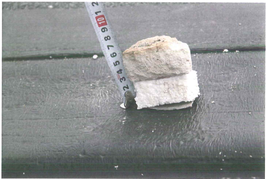
Pobrana próbka/część stara/ – gładź, styropian, papa
